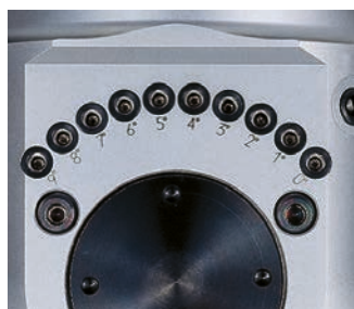
Mécanisme de réglage de l'angle de la broche porte-pince, incrémentation : 1°.
